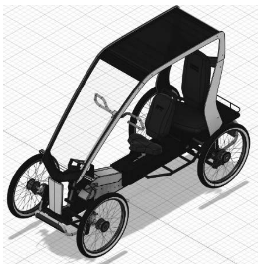
図5 2021年度車体の3次元モデル
