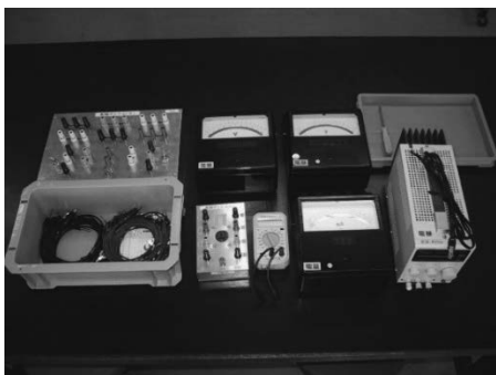
図 1-1 各実験班の机の上に置かれる機材の例：左奥が配線ボックスで電源・素子・測定器を空中配線にせず配線できる。ドライバは測定器の零点校正用。
