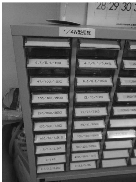
図 1-2 実験室の共用素子ボックス：学生は班ごとに適当な素子を選んで回路を組む。当然だが抵抗値、静電容量値などは特定の値のものしかないため、学生の想定したとおりのものがあるとは限らない。
