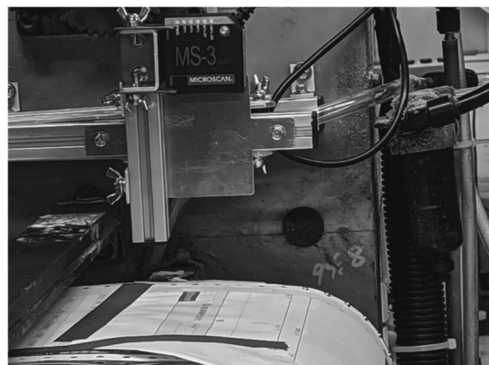
図 6 バーコードリーダの取付方法
