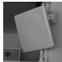
(b). アンテナ : Wireless Edge, MT262030, 9dB
