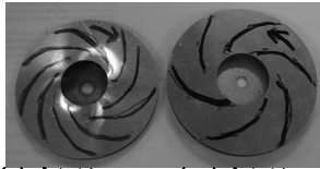
(a) 右回り (時計方向) (b) 左回り (反時計方向) 図2 小型整流子電動機のファン
