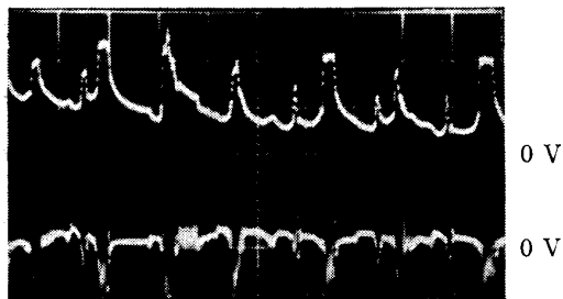
写真 3 上: ブラシ間 ( B_1-B_2 ) の電圧波形 下: 電流プローブの出力波形 V: \begin{cases} \text{上} & 50 \text{ V/div} \\ \text{下} & 5 \text{ mV/div} \end{cases} , H: 0.1 \text{ ms/div} , B_p = 230 \text{ g} , 負荷の種類: D, N = 15100 \text{ rpm} .
