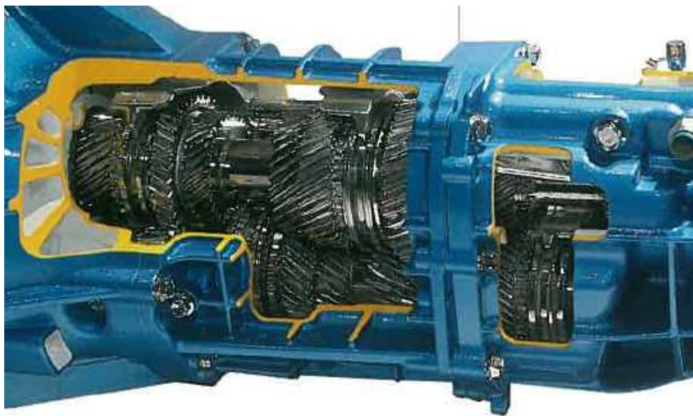
図 1.1 MT (Manual Transmission) の機構
