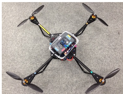
図 1.1 自立飛行型マルチロータの一例（ELEV-8 Quadcopter Kit をベースとする自作のクアッドロータ）
