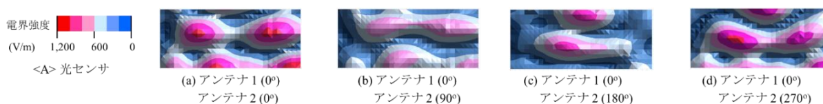
図 4.9 アンテナ 1 を 0^\circ ， アンテナ 2 を 0^\circ ， 90^\circ ， 180^\circ ， 270^\circ に設定した場合の電界強度分布の測定結果
